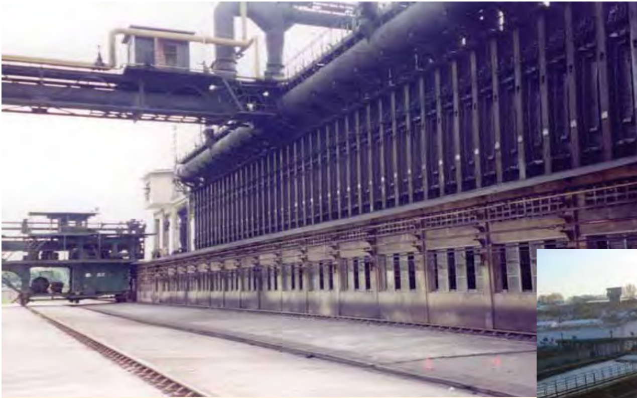
本溪北台製鉄工場のコークス炉 移転点検プロジェクト
